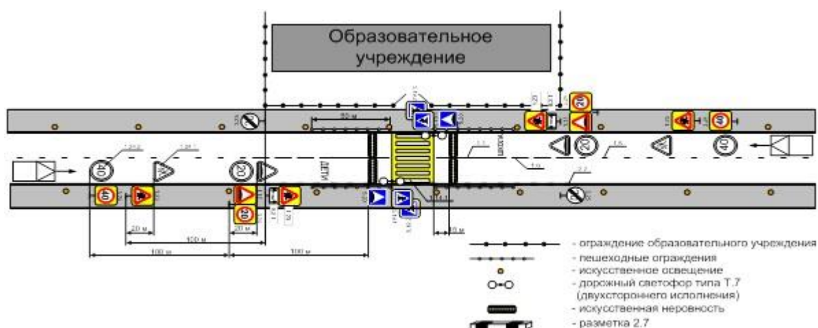
Рис.3 Пример нанесения дорожной разметки
